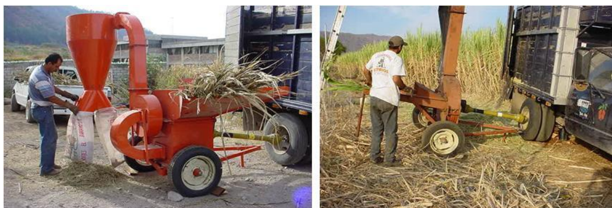
Figura 2. Equipamento agrícola fixo conectado à tomada de força do caminhonete
